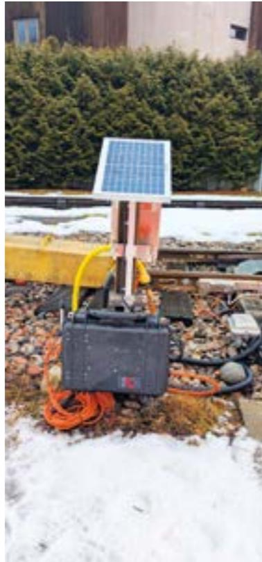
Ce prototype de REG'GAZ, qui vise à éviter les amas de neige et la formation de givre sur les appareils de voie, teste la régulation de la température.
